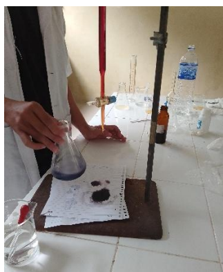
Gambar 16. Uji Vitamin C dengan metode titrasi
