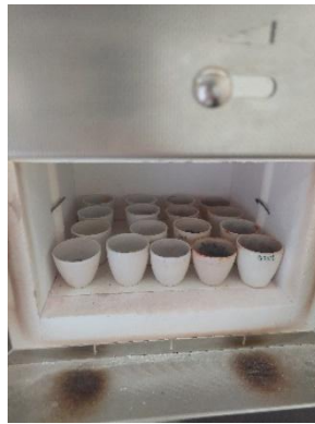
Gambar 14. Uji kadar abu menggunakan tanur
