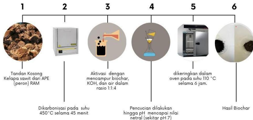
Gambar 10. Alur sintesis Biochar
