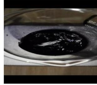
Dipanaskan campuran menggunakan stirer hotplate dengan kecepatan 200rpm selama 4 jam
