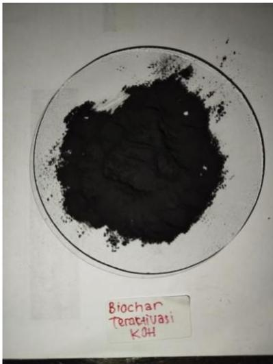
Dikeringkan biochar menggunakan oven pada suhu 110°C selama 4 jam
