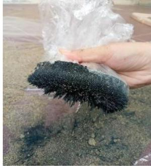
Disaring pasir berwarna hitam pekat menggunakan magnet batang
