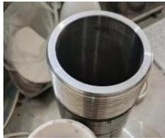
Dimasukkan campuran tersebut ke dalam reaktor hidrotermal
