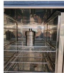
Ditutup reaktor dan dipanaskan pada suhu 150 °C selama 3 jam
