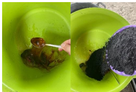
Gambar 3. Pembuatan prekat dan pencampuran bahan
