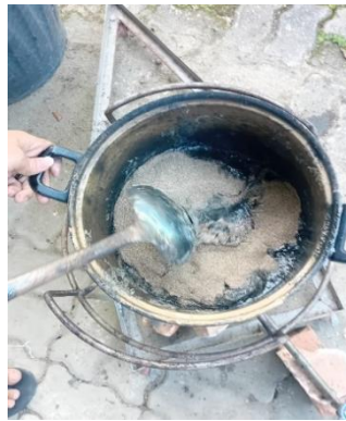
Proses Pencampuran Pasir dan plastik PP
