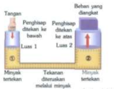
Gambar 2.1 Prinsip kerja penghasil gaya hidrolik
