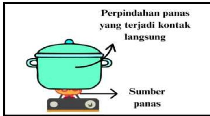
**Gambar 2.3** Ilustrasi perpindahan kalor secara konduksi pada panci
