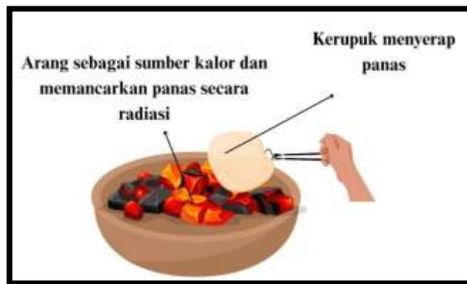
**Gambar 2.8** Ilustrasi perpindahan kalor secara radiasi selama pemanggangan kerupuk
