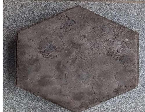
Gambar 12. Paving block dari plastik
