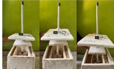
Kotak fermentasi dilengkapi alat pengaduk dan alat termometer yang terhubung pada penutup kotak luar dengan kotak dalam.
