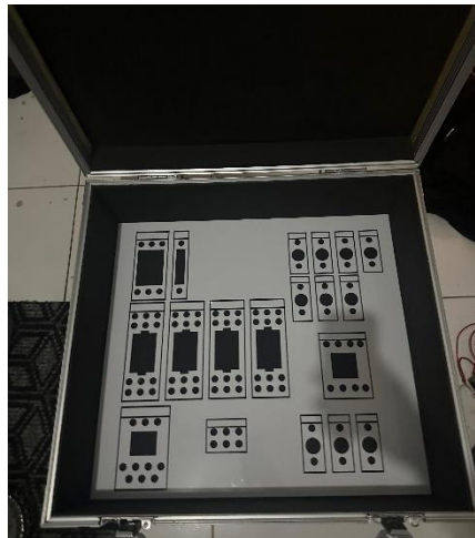
Gambar 28. Penempatan akrilik di cover box yang sudah dipotong
