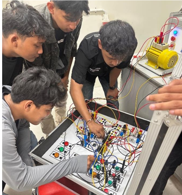
Gambar 43. Proses pengujian dan penjelasan setiap bagian posisi kabel jumper
