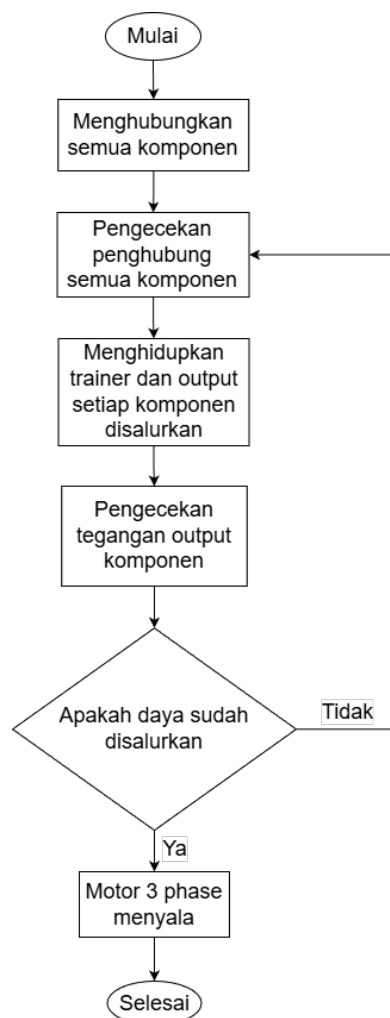
Gambar 25. Diagram Alir Prinsip Kerja Rangkaian Elektrik
